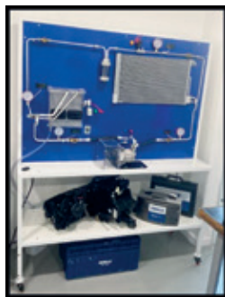
Figura 3. Bancada didática de simulação do sistema de ar condicionado automotivo. Fonte: Sistema FIEC.
