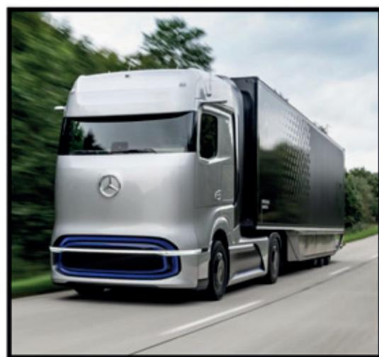
Figura 4: Mercedes Benz GenH2, caminhão movido a hidrogênio com autonomia superior a 1000 km. Fonte: Revista Autoesporte.
